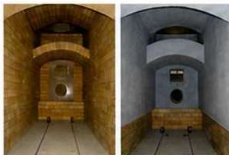
レンガ炉(左)からセラミック炉(右)への改善例
